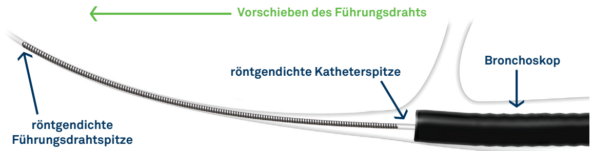
Abbildung 3: Vorschieben des Führungsdrahts in die zu behandelnden Atemwege
