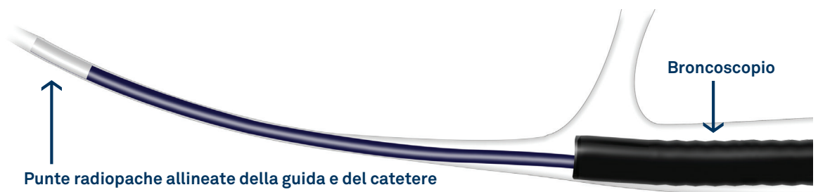
Figura 4: Punta del catetere allineata con la punta della guida
